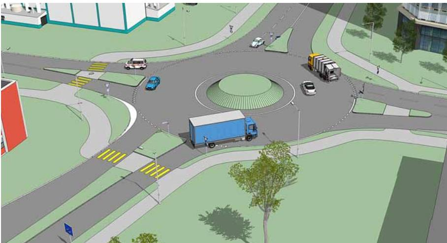
Vorteile rundum: Der Kreisel verflüssigt den Verkehr, vermindert den Stau und erhöht die Sicherheit.
